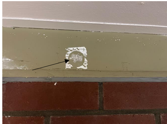
Abb. 18: Probe 15, Raum 313, Wand 1, Unterzug, oliv beschichtet, weiße gespachtelt, asbesthaltig
