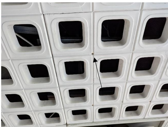
Abb. 8: Probe 5, Material am Schraubenkopf, ohne Befund
